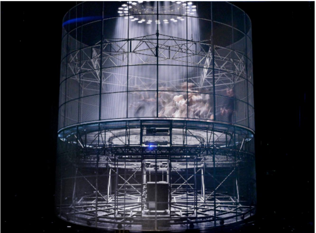
La machine scénographique est constituée de 3 éléments principaux : La base et sa couronne (*wreath* sur le schéma ci-dessous) sont posées sur une tournette (*turntable*). Puis vient la cassette, qui peut faire des mouvements de va-et vient. Enfin, le plafond, cylindre suspendu en trois point aux cintres, apporte une dimension supplémentaire à la machine.
